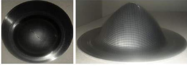
Şekil 10. 120 Bar basınç 'da oda sıcaklığında numunenin şekillendirme işlemi sonrası fotoğraf görüntüsü
