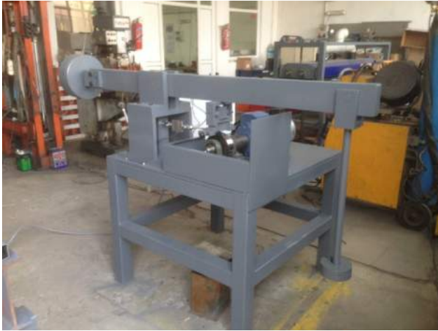
Şekil 4. Blok-Disk Aşınma Cihazının İmalat Resmi
