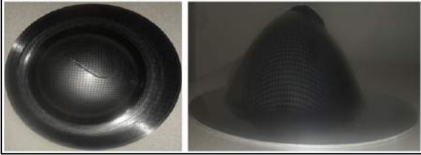
Şekil 11. 180 Bar basınç 'da oda sıcaklığında numunenin şekillendirme işlemi sonrası fotoğraf görüntüsü
