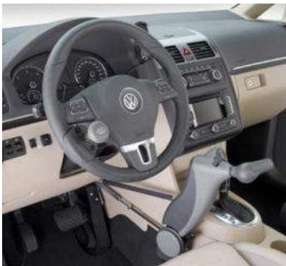
Şekil 4. Elle kontrol edilen gaz-fren sistemi
