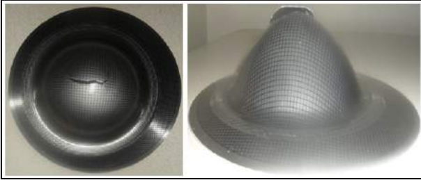
Şekil 13. 300 Bar basınç 'da oda sıcaklığında numunenin şekillendirme işlemi sonrası fotoğraf görüntüsü
