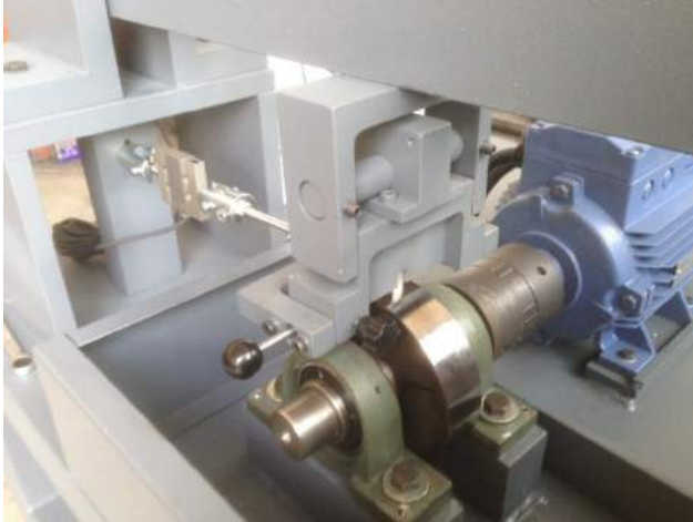
Şekil 5. Blok-Disk Aşınma Cihazının Numune, Numune Tutucu ve Aşındırıcı Diskin Yakından Görünüşü
