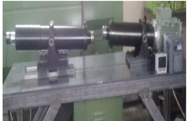
Şekil.3. Dönel eğmeli yorulma cihazı üzerine monte edilmiş fener milleri.
