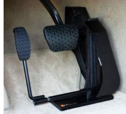
Şekil 6. Sol ayakla gaz kontrolü
