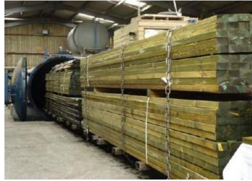
Şekil 2. Kerestenin emprenye edilmesi
