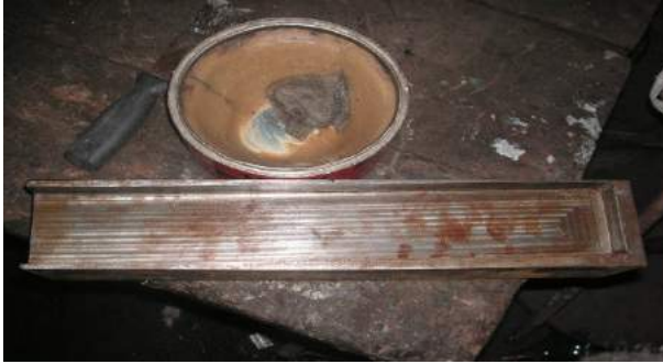
Şekil 5. Kalıp ayırıcı vaksın kalıba uygulanması
