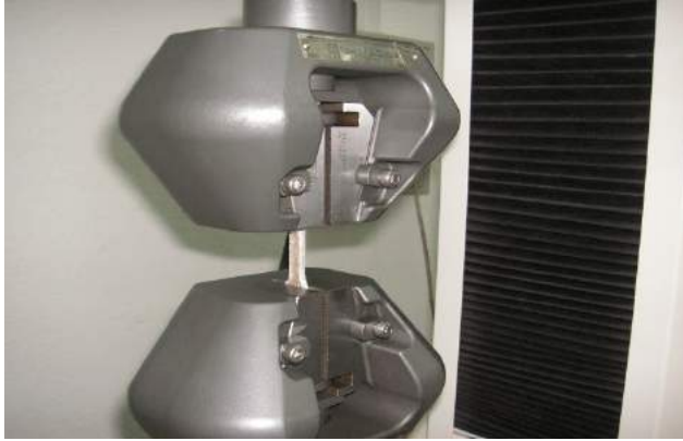
Şekil 11. Yay numunesi çekme deneyi
