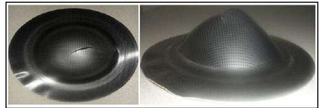
Şekil 9. 60 Bar basınç 'da oda sıcaklığında numunenin şekillendirme işlemi sonrası fotoğraf görüntüsü
