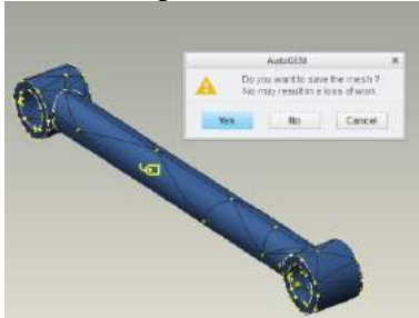
Şekil 24. Simulate ortamında parçanın sonlu elemanlara bölünmesi (mesh).
