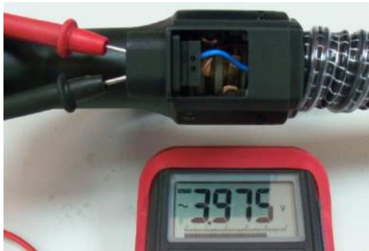
Şekil 3. Tetik fiş yatağında elektriğin multimetre ile denetimi
