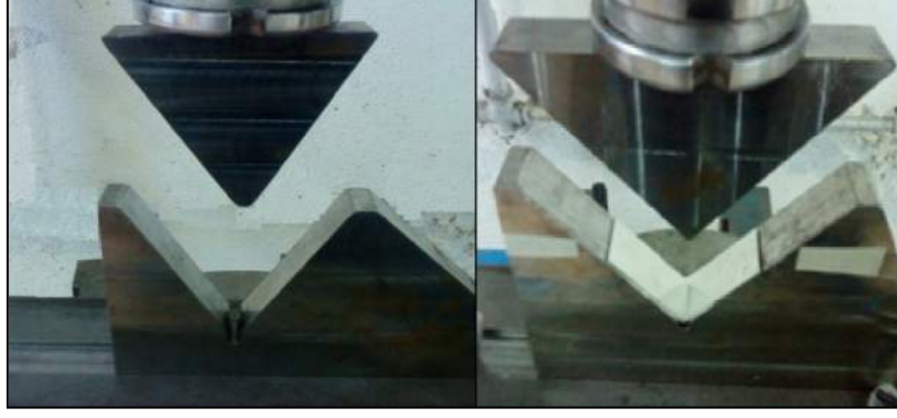
Şekil 3. Farklı tasarımlarda imal ettirilen kalıpların bükme açıları a) 60°, b) 90° olan kalıp ve zımba setleri [12,13].
