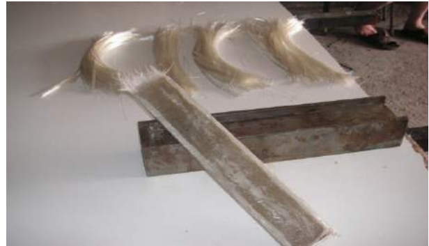
Şekil 10. Polimer kompozit yayın kalıptan çıkarılması
