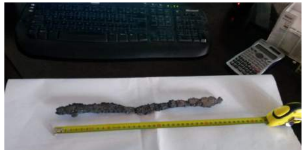
Şekil 9. Son tasarlanan makine ile kökten kırılarak çıkarılmış çapak
