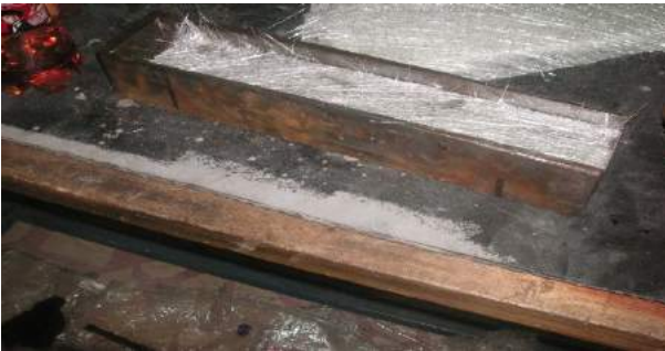
Şekil 7. Cam elyaf keçenin kalıba uygulanması
