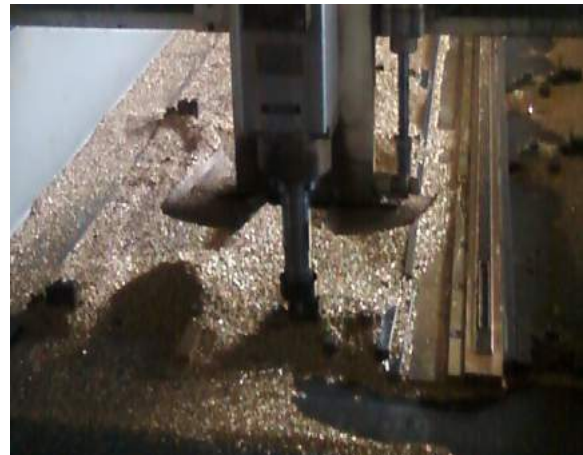
Şekil 11. Kemer desen kalıbının CNC tezgâhında işlenmesi
