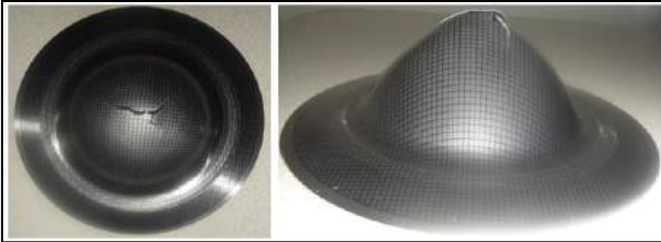
Şekil 12. 240 Bar basınç 'da oda sıcaklığında numunenin şekillendirme işlemi sonrası fotoğraf görüntüsü
