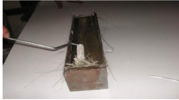
Şekil 9. El yatırması yöntemi hava alma işlemi
