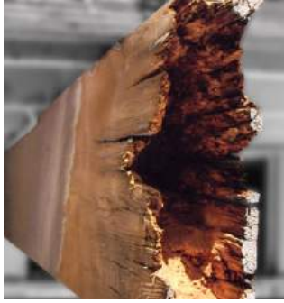
Şekil 1. İçeriden çürümüş bir kiriş kesiti
