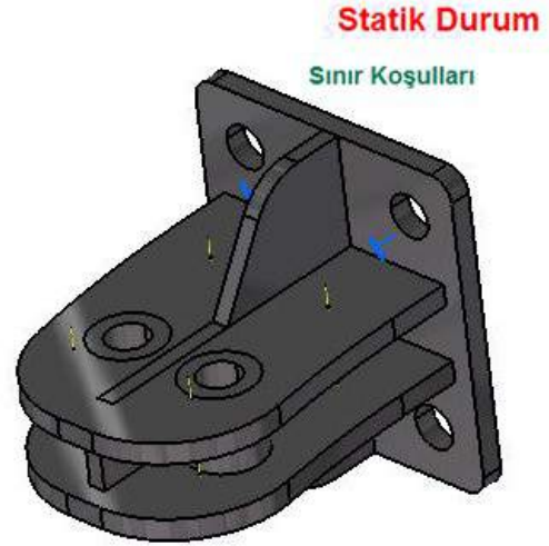
Şekil 6. Motor bağlantı kulağının statik durumu
