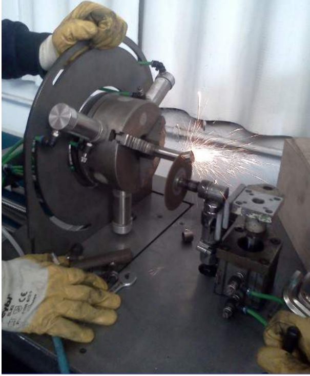
Şekil 9. CNC Boru Bükme ve Kesme Tezgâhı Prototip Yapım Aşamasından Bir Görüntü (Kesme Operasyonun denenmesi anı)
