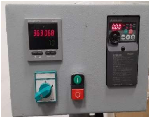
Şekil 5. Cihazın panosu üzerinde sayaç ve sürücü.
